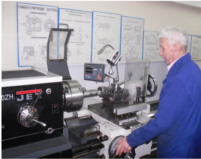
Рис. 1. Экспериментальный стенд на базе токарно-винторезного станка GH2060ZH
